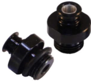
N050 G1/8-AG 040.01.702.106 G1/8"AG, kraag Ø14 mm, met O- ring en geïntegreerd filter
