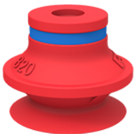
Suction cup B20.20 0101102 Ø 22 mm, HF = 9,8 N, veerweg = 10,0 mm, zonder nippel, SI (50°)
